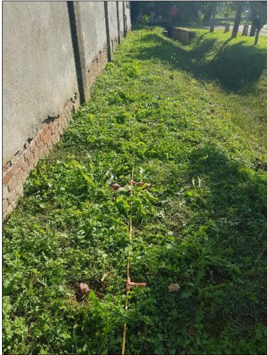
Stendimento Sismico M.A.S.W. 3
