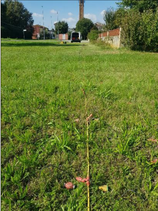
Stendimento Sismico M.A.S.W. 1
