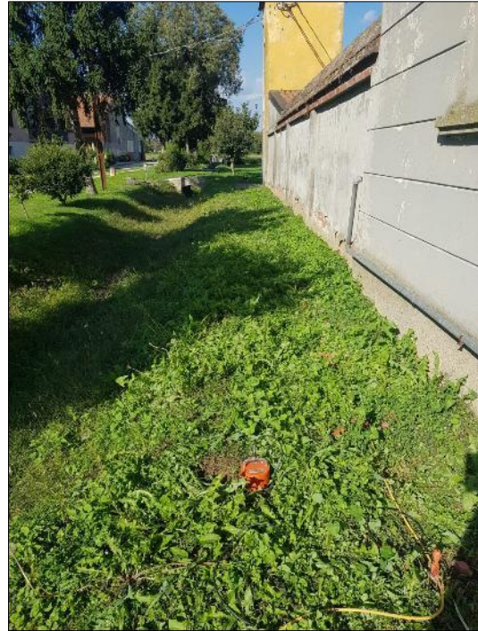
Misura del microtremore sismico mediante tecnica H.V.S.R. 3
