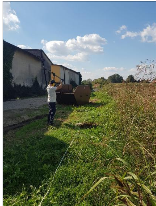
Acquisizione del segnale sismico con Sismografo Geometrics Mod. Geode 3-1000
