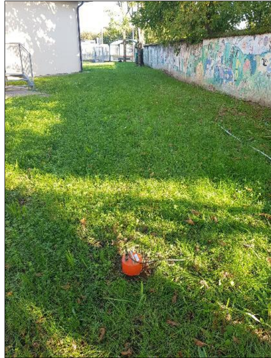
Misura del microtremore sismico mediante tecnica H.V.S.R.4
