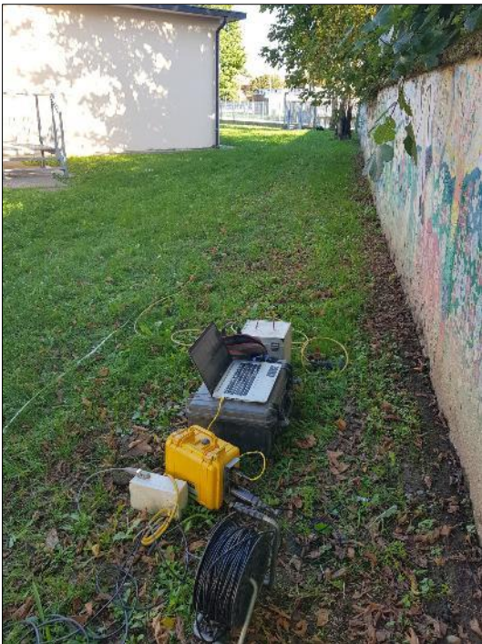
Acquisizione del segnale sismico con Sismografo Geometrics Mod. Geode 3-1000
